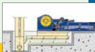
виброжелобом и ковшевым элеватором (возможен одновременный отсев)
